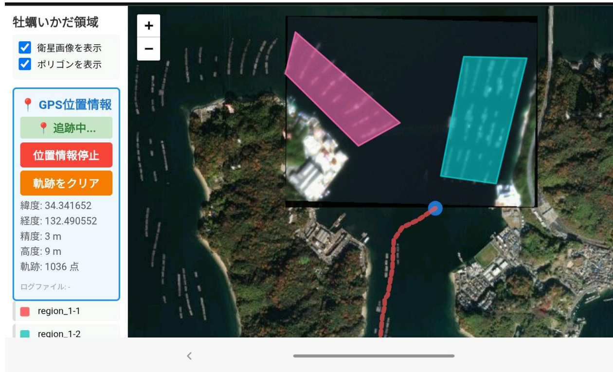
衛星画像・かき養殖筏エリア・航跡データの重畳表示イメージ
