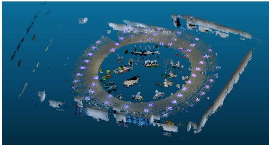
(b) カメラ画像、LiDAR測距データから生成された3Dモデル例
