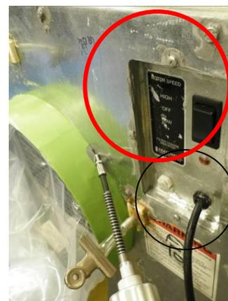
参考図3.31 電源コード取り付け部ダクト接続口取り付け部
