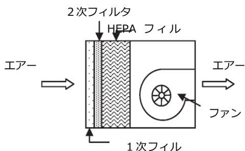
参考図 3.12 集じん・排気装置の構造図
