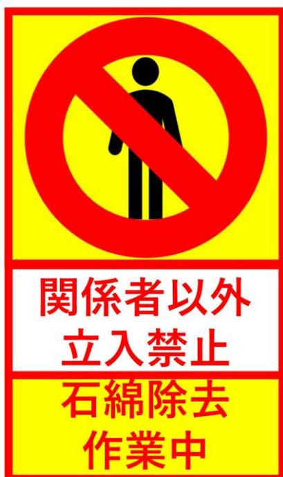
図4.6.4 石綿則による「石綿等を取り扱う作業場である旨、石綿の人体に及ぼす作用、石綿等の取扱い上の注意事項、使用すべき保護具」の掲示例
