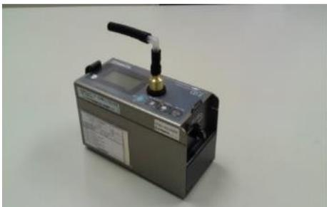
参考図 3.26 排気風管のアルミダクトの中へ直接粉じん相対濃度計を設置する場合
