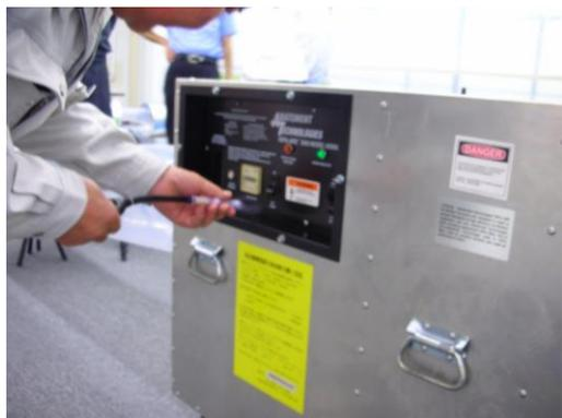
参考図3.29 コントロールパネルの接合部スイッチ等の取り付け部
