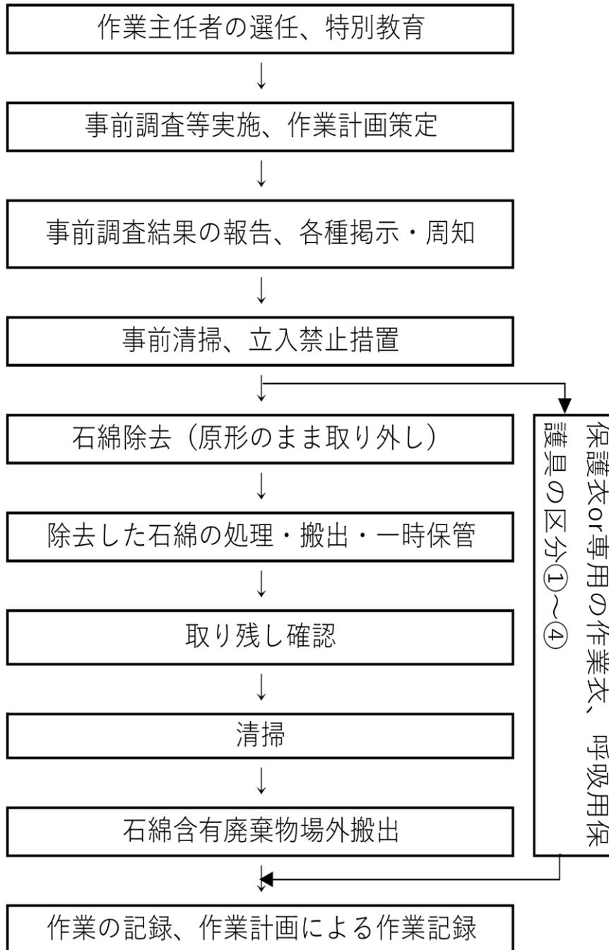
図 4.2.5.1 切断等をしない除去作業の手順
