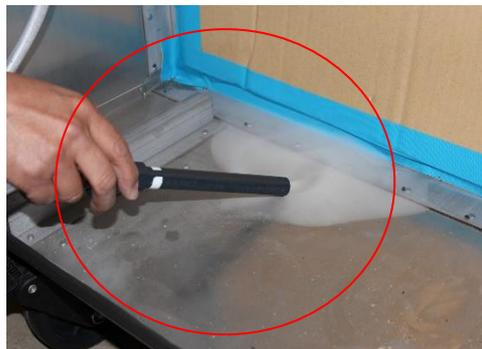
HEPA フィルタ取り付け面の隙間から煙が吸い込まれていく
