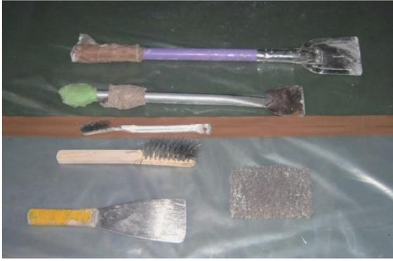
参考図 3.34 除去作業用の手工具の例
