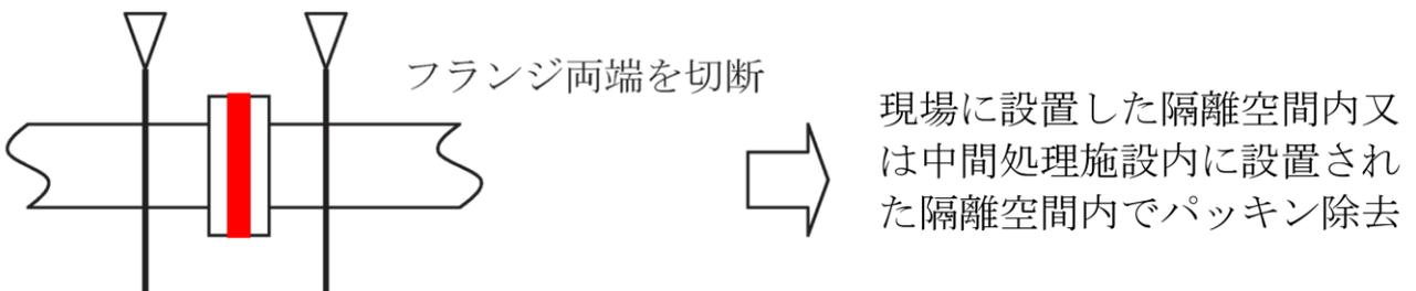
図4.10.10 配管用シートパッキン解体・撤去例
