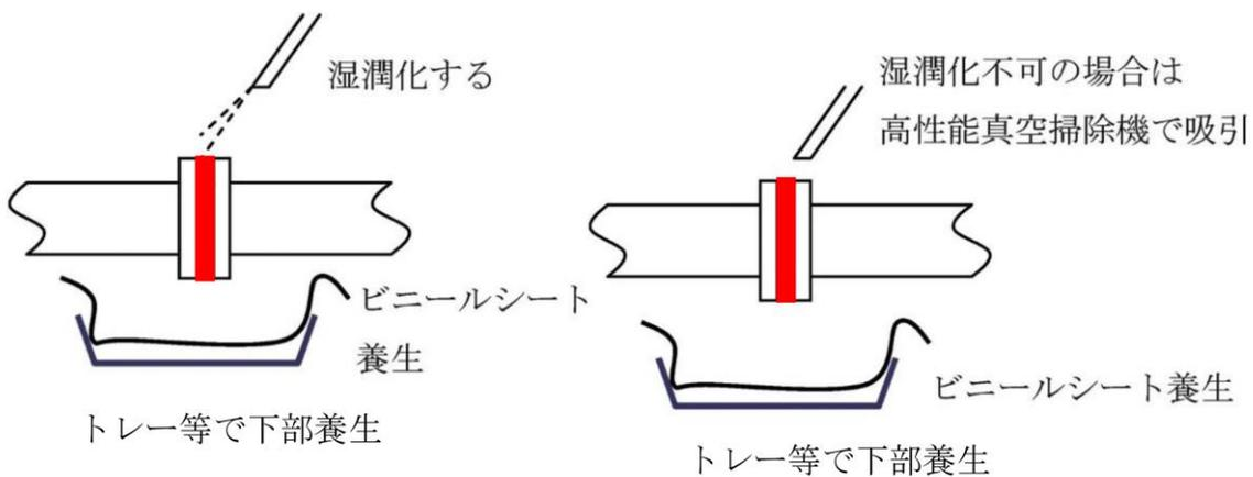
図4.10.9 配管用シートパッキン除去施工例
