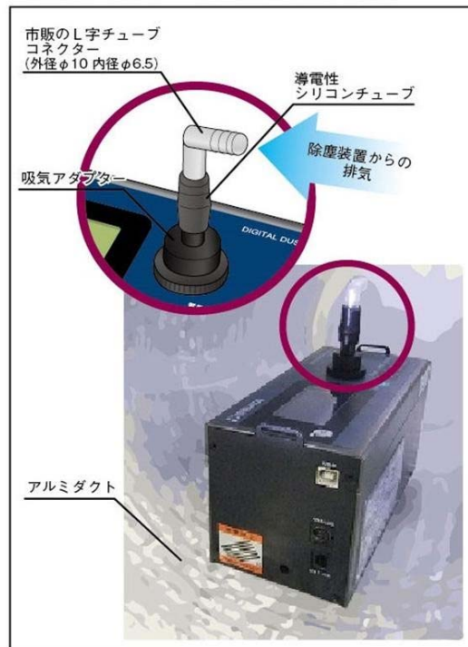
参考図 4.16 ダクト内の排気を直接測定する場合の測定例
