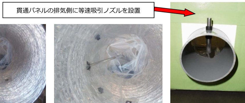
参考図 4.17 等速吸引ノズルを使用した場合の排気ダクト内の測定例
