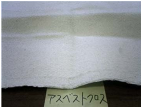
図 2-5 アスベストクロス（左）及び アスベストクロスを巻き付けた蒸気配管（右）
