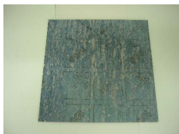
参考写真 5.3 フランジパッキン
