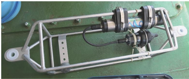
図 4.1.2—センサーケージに固定されたハイドロフォン
