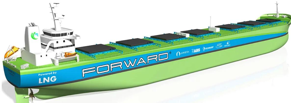
LNG 燃料カムサマックス型ばら積み運搬船のイメージ図
