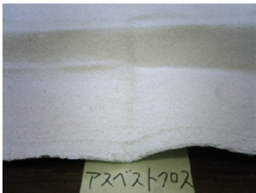
図 2-5 アスベスト糸を布状にしたクロス（左）及び アスベストクロスを巻き付けた蒸気配管（右）
