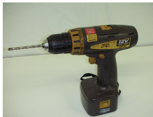
写真 8. 工程 3 電気ドリル (松下電工 MYJOY EZT107)
