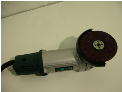
写真 7. 工程 2 ディスクサンダー (HITACHI PDA-100F)
