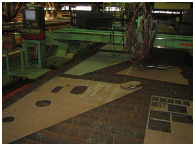
(d) R処理装置改造したNC切断機(1)
