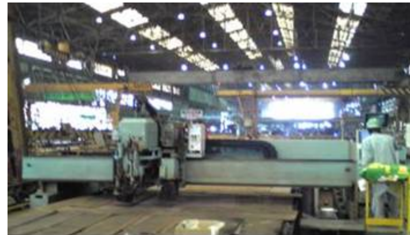
(e) R処理装置改造したNC切断機(2)
