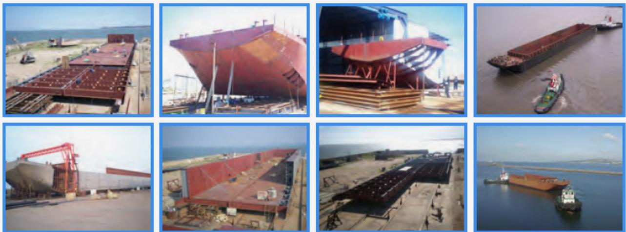
Parana Sur 造船所は、新造船及び修繕・改造、メンテナンス工事他、バージ建造を最大の売り物にしており、他にも様々な河川用船舶を建造している。同造船所は、LoA20メートル、喫水3メートル、600トンG/T規模までの“ジャンボ”バージ10隻の同時建造が可能である。ブエノスアイレス県のLa Plata市にある。
