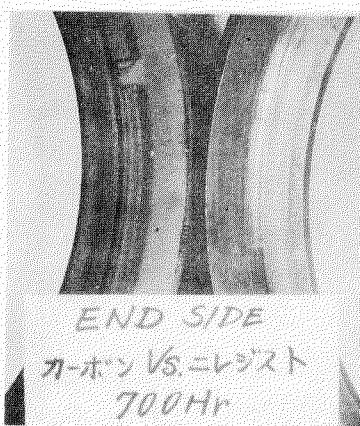
図1.1.25 反駆動側700時間後の摺動面
