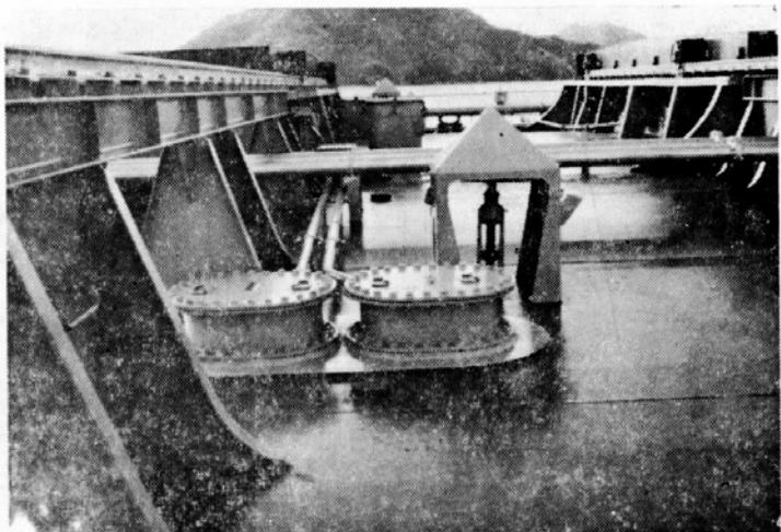
Photo 5.7 計測用配管とマンホールコーミング
