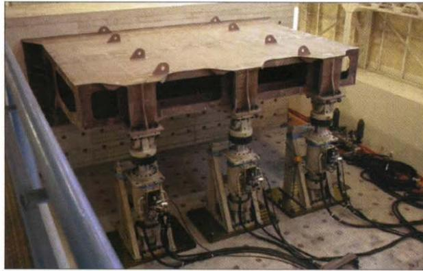
⑦SR245 大型模型疲労破壊実験
