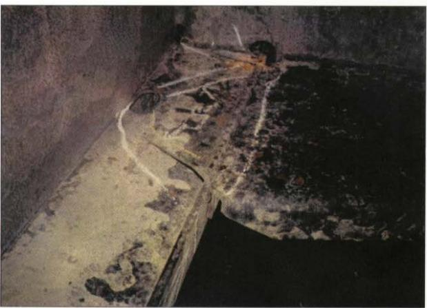
③サイド ロンジ 部疲労亀裂事例 (S/H タンカー)
