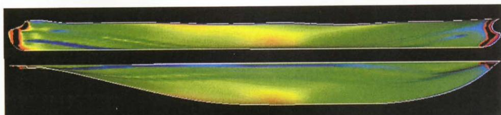
図 5.1.3 Cf 分布計算結果（空気を吹き出したとき）
