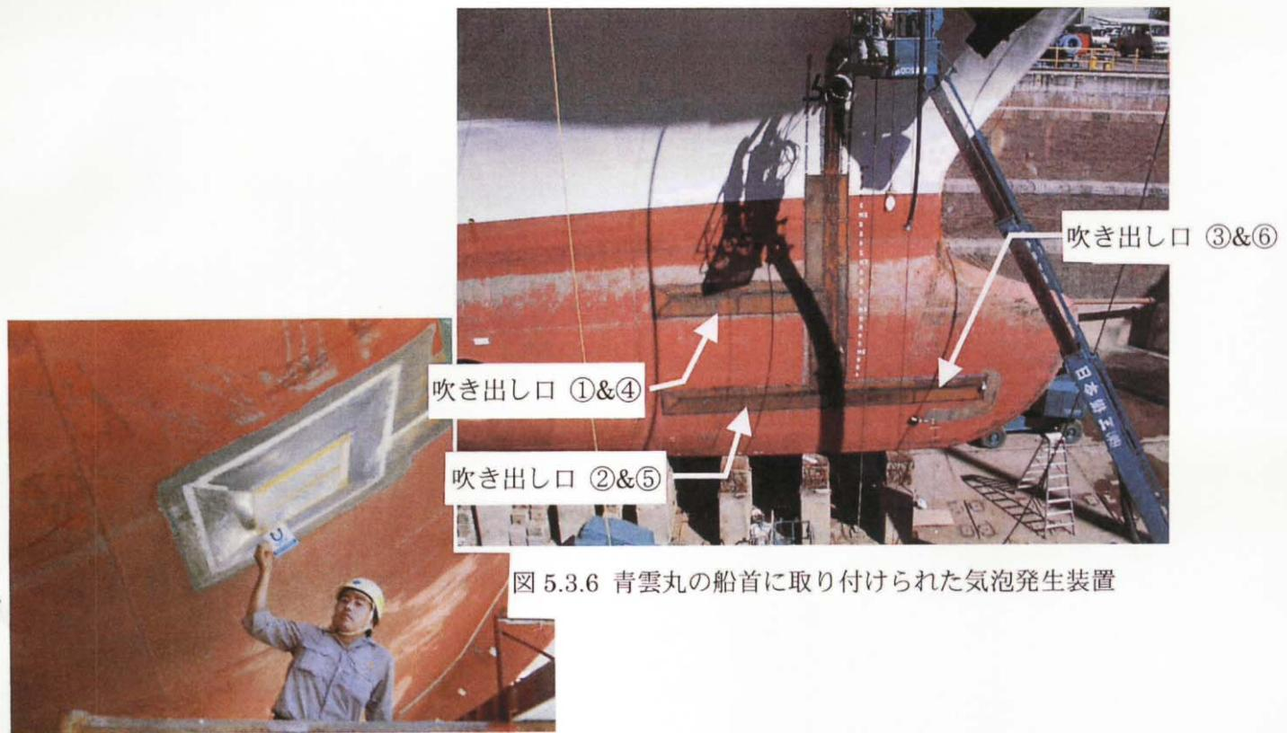
図 5.5.6 青雲丸の船首に取り付けられた気泡発生装置
