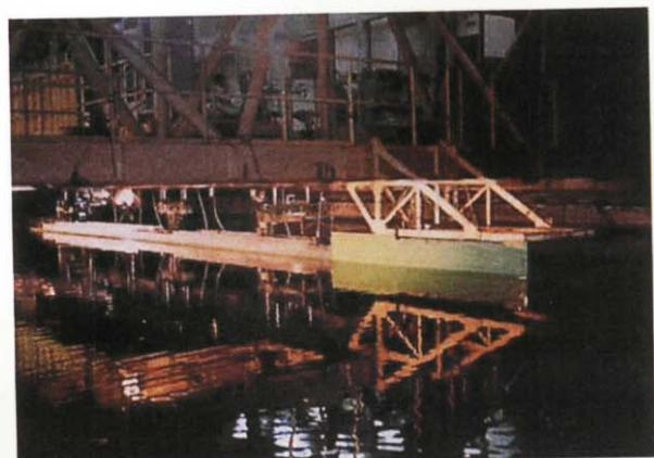
図 3.2 超大型模型船試験
