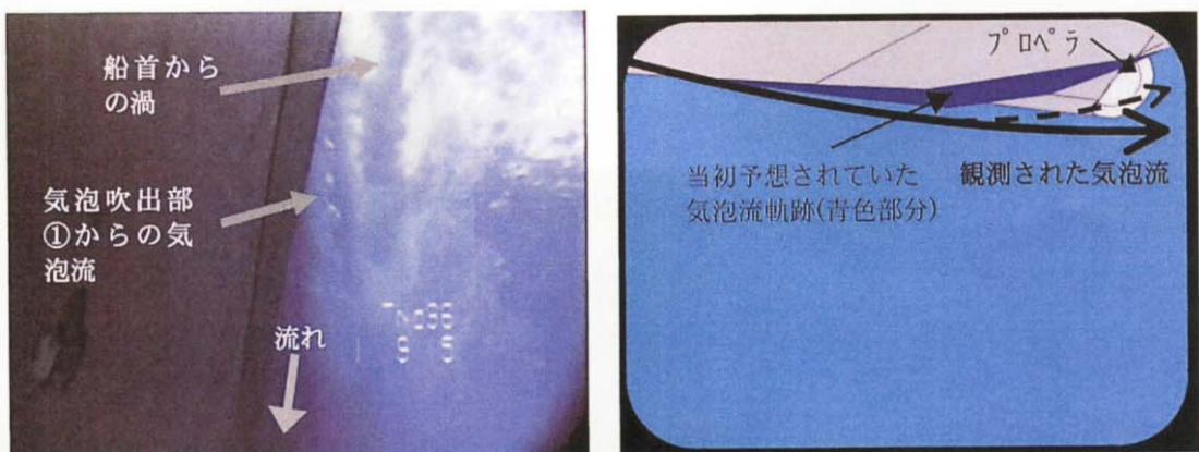
[船首気泡吹出し部を見上げた映像] [BKから船尾方向を観察した結果の模式図]
