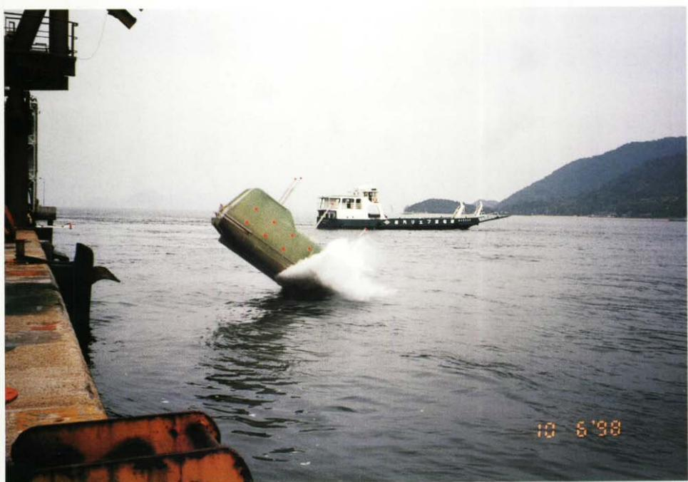
大型模型艇の落下実験
