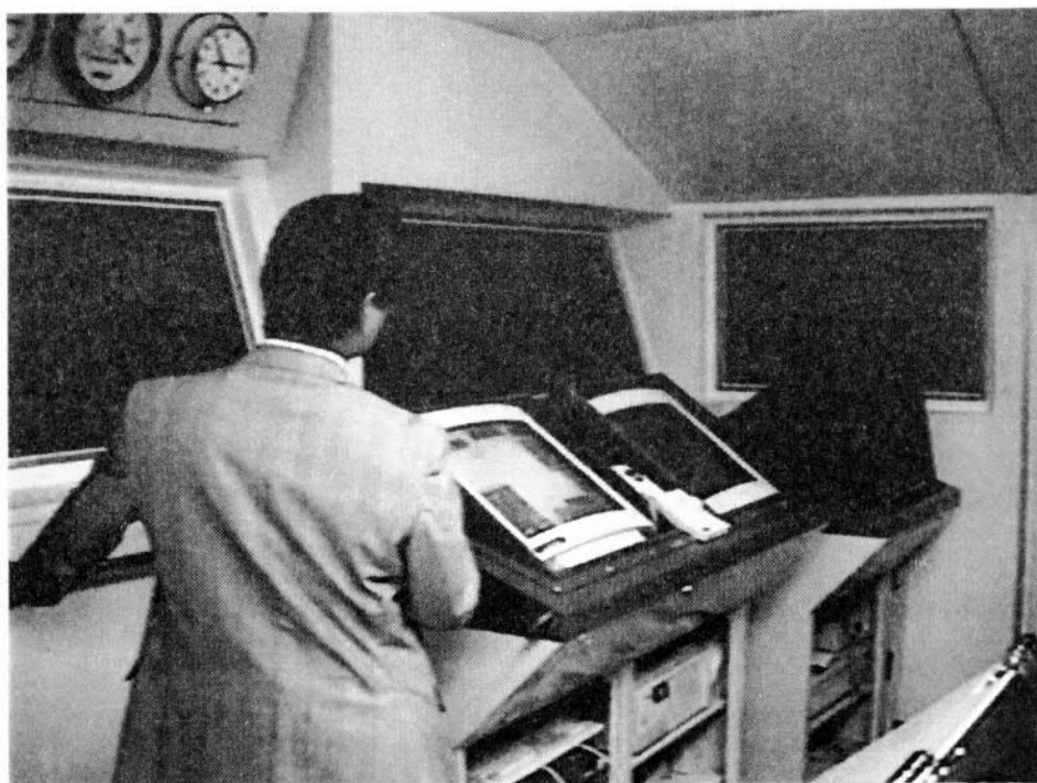
図5.6.3 ブリッジ内部 (右舷前方に配置した供試システム) 左: 自動運航システム (CRT 2台) 右: トランスポンダシステム
