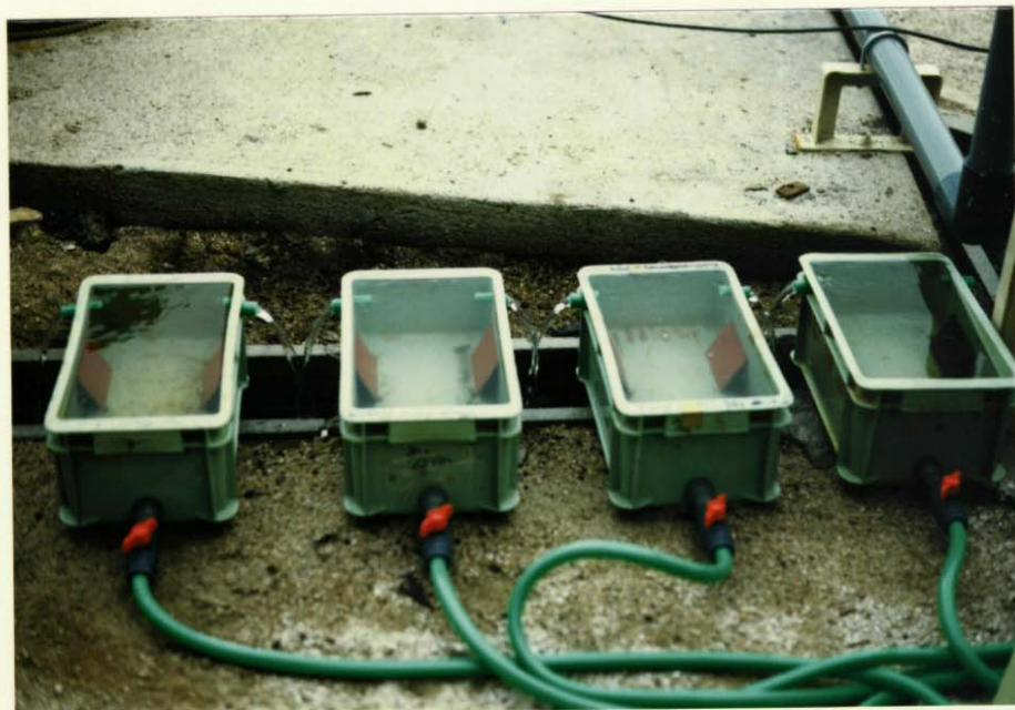
図4.2.3 スライム付着試験水槽（流速0.5m/s）
