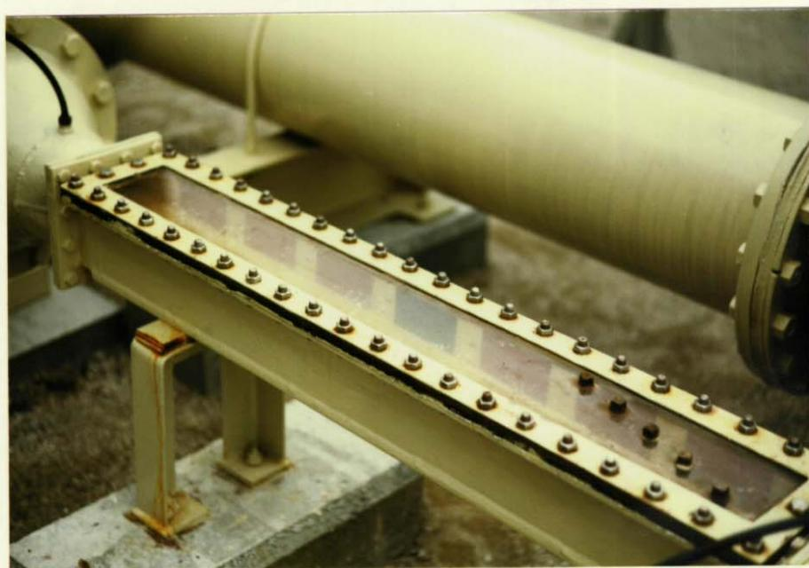
図4.2.4 回流水槽テストセクションの試験片取付状況
