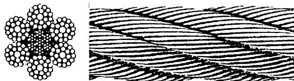
また、ストランドロープの心の種類としては、サイザル、ジュート（黄麻）等の天然繊維やポリプロピレン等の合成繊維を使用した繊維心（Fiber Core, FCと略す）、ストランドを中心とした、ストランド心（Independent Wire Strand Core, IWSC）ロープそのものを心としたロープ心（Independent Wire Rope Core, IWRC又は、Center Fit Rope Core, CFRC）がある。
