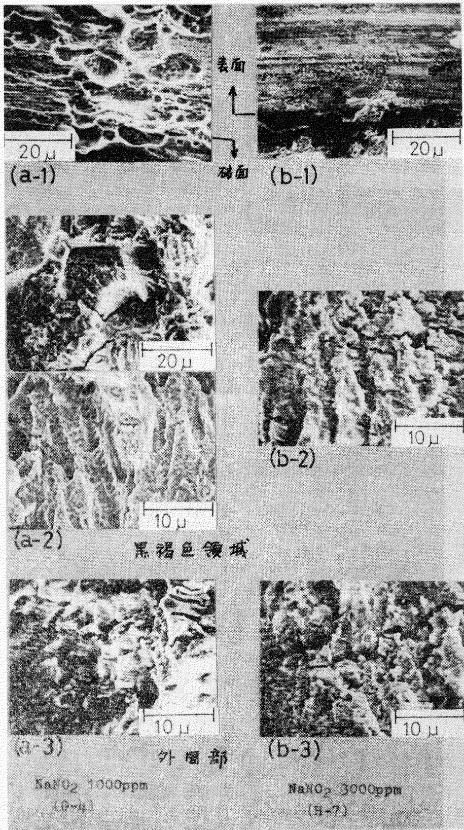
図 1.1.15 腐食疲労試験片の電子顕微鏡写真
