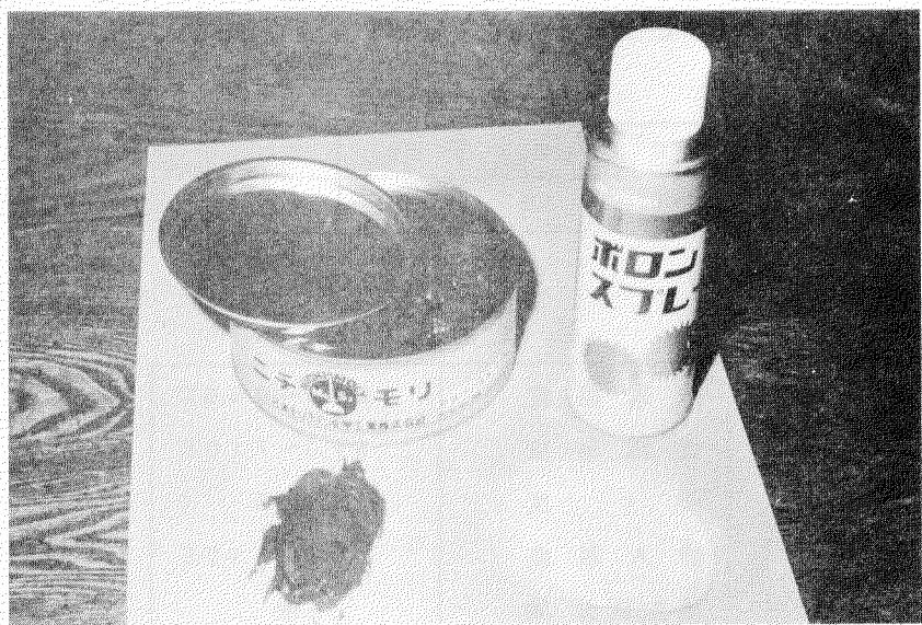
図 2.2.2 燃料炉内防錆用塗付剤
