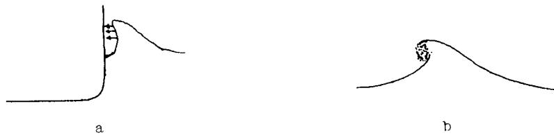
単独の波が steep になって崩れた後は崩れた波頂は斜面に沿って重力によって加速され、位相速度に等しくなるが、このような碎波は空気を含んでいて余り大きな衝撃圧を生じないことが実験により確かめられているので今は考慮しない。
