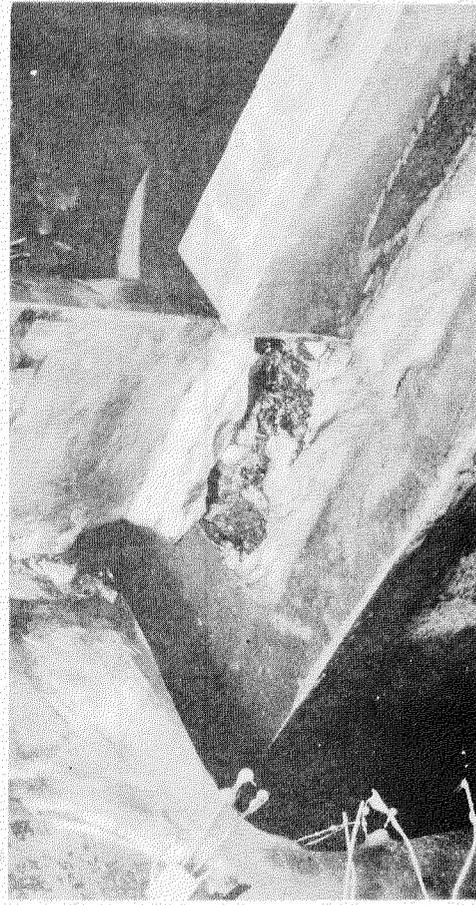
写真 1.2.8 M-1 模型のステイフナー基部における疲労破断
