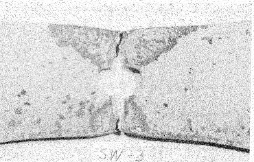
写真 3.3.1 破断時における表面腐食状況
