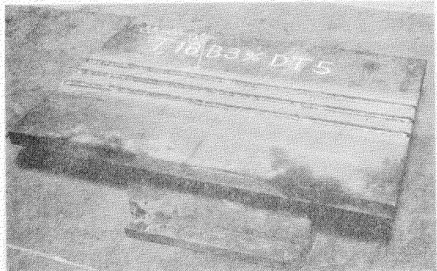
写真 3.2.2 溶接後の外観（二重引張試験用）
