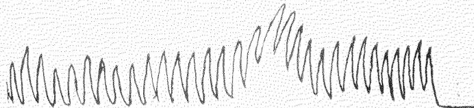
図 4. 5. 7 900 cpm時の振幅。全振幅5倍図
