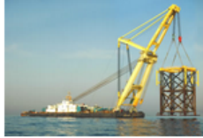
Sheerlegs Crane/ Pull Barge SADAF 3000
