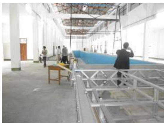
写真 1.7 試験水槽製作中（英国製）
