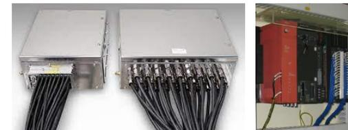
デジタル化で密集するケーブル配線（左）と船用品がない電気制御装置PLC（右） 1
