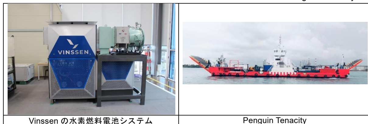
図 18 Vinssen の水素燃料電池システムと試験運航用 Ro-Ro 船 Penguin Tenacity
