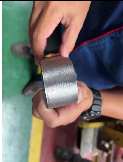
溶接サンプル（曲げ試験）
