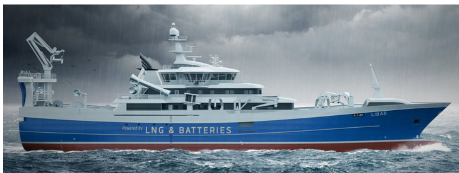
バッテリー・LNG 駆動巾着網漁船「Libas」
