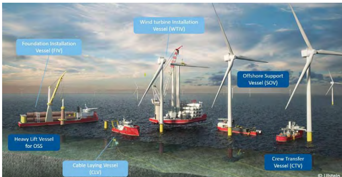
図 6 着床式洋上風力発電の設置・維持管理に用いられる船舶
