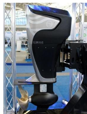
図 37 電動船外機 ÅRKA
