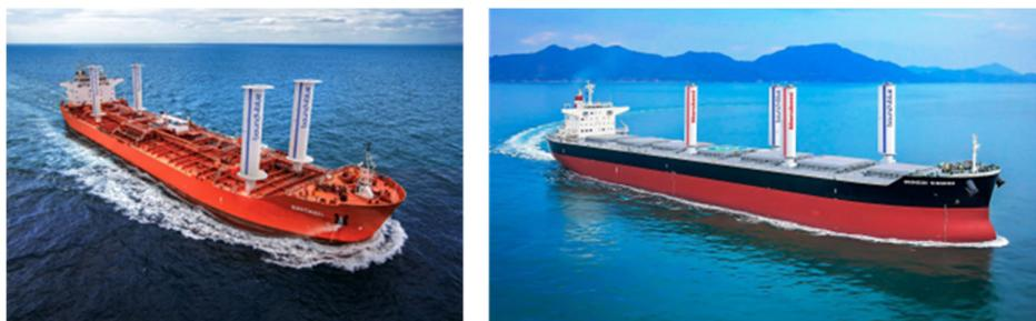
図 26 eSAIL システムの実証船
