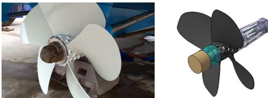
図 20 CoPropel で開発するプロペラ
