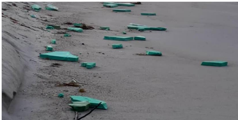
図表 31 ナンタケット島のビーチに漂着した、故障したヴィンヤード・ウインドの風力タービンブレードの破片
