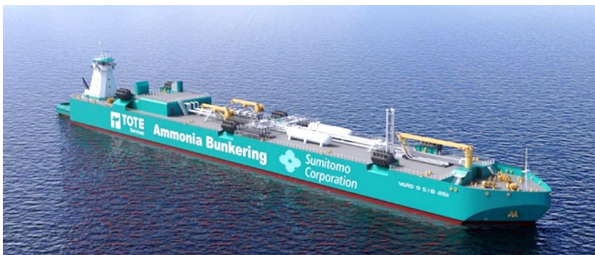
図表 51 米国東海岸の港湾でのバンカリング用に設計されたアンモニアタグ・バージ
