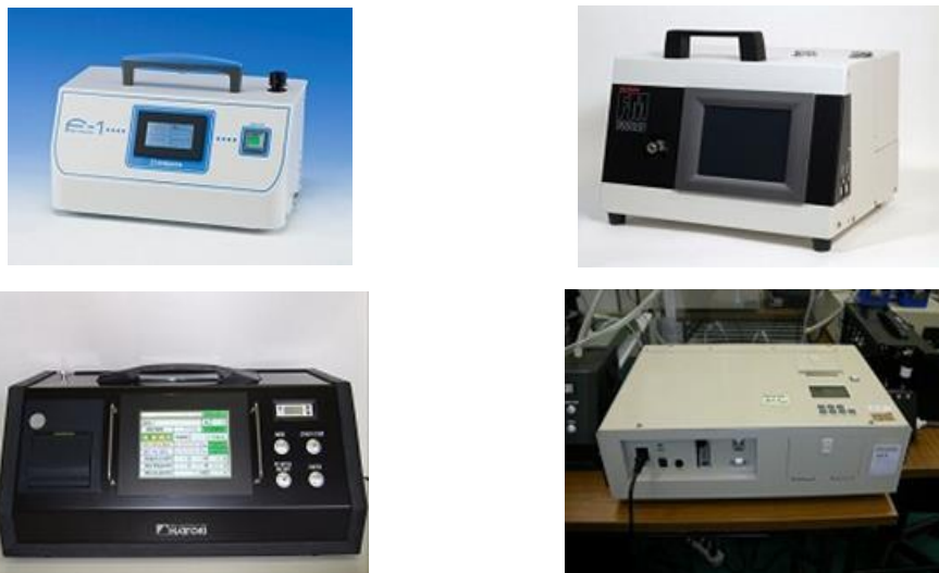
参考図 4.4 繊維状粒子自動計測器の例
