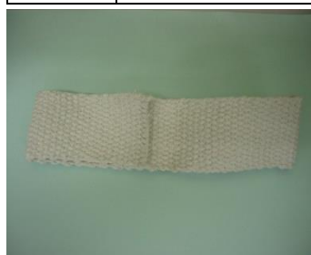
参考写真 5.2 アスベストリボン
