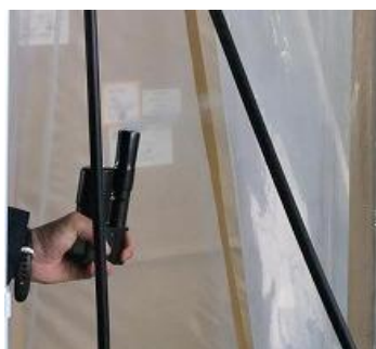
参考図 4.9 セキュリティーゾーンの入口の気流方向の確認
