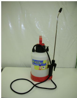
写真 5. 散水に使用した器具 (オートスプレー ε-value AS-2500N)
