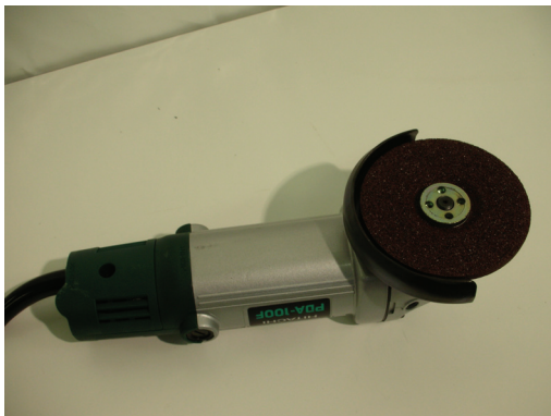
写真 7. 工程 2 ディスクサンダー (HITACHI PDA-100F)
