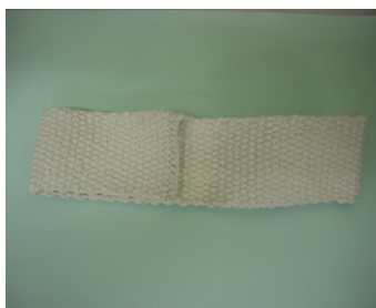
写真2. アスベストリボン
