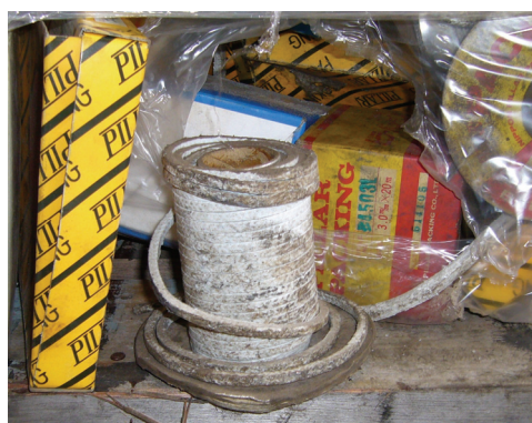
図 2-10 低圧配管用フランジシートパッキン（左）及び 弁グラントパッキン（右）
