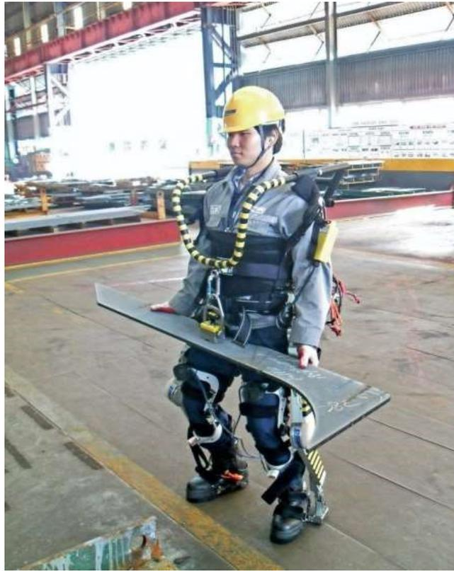
図 3-3 ウェアラブルロボット「Iron Man」(出所：DSME)
