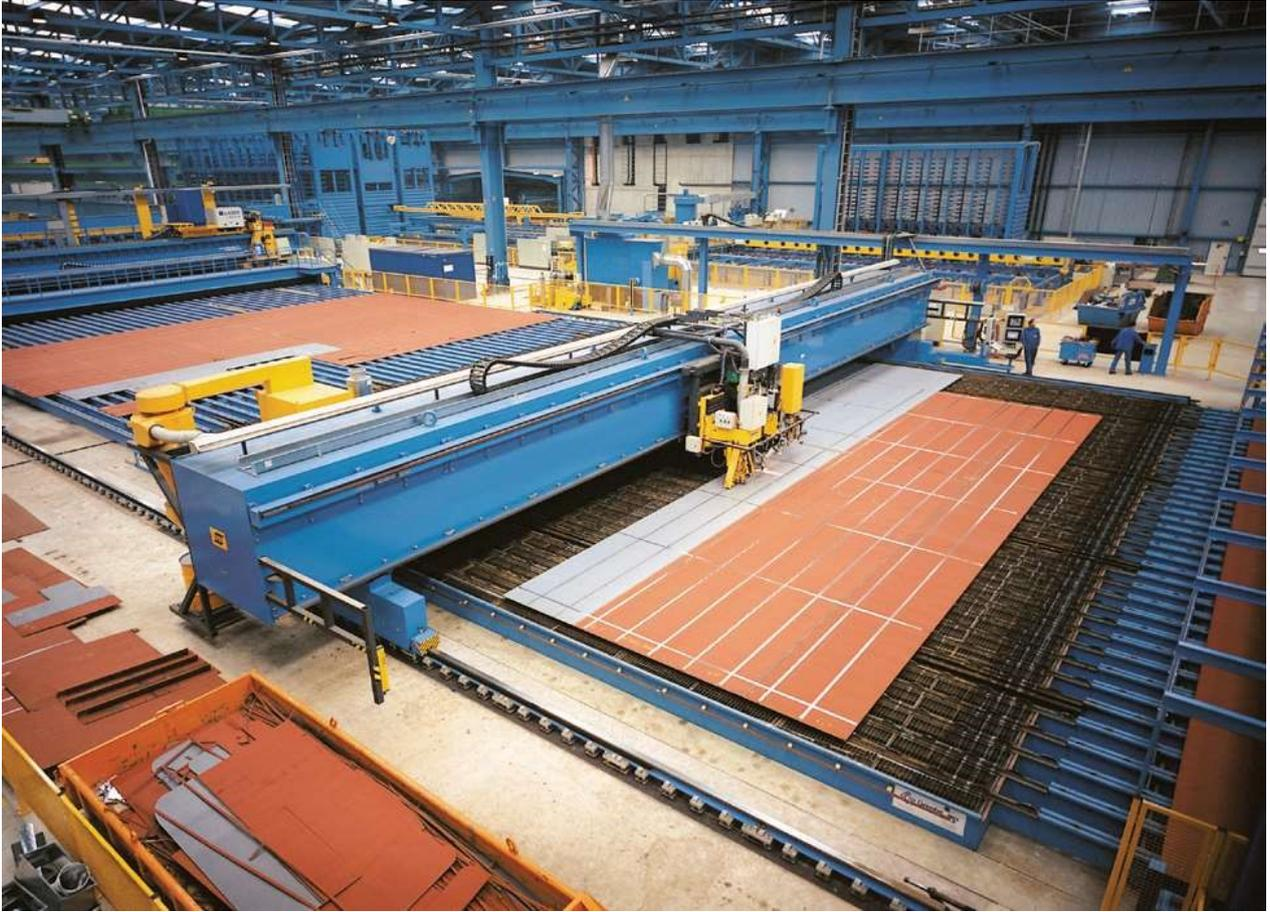
図 2-10 世界最大級のレーザー溶接設備：
