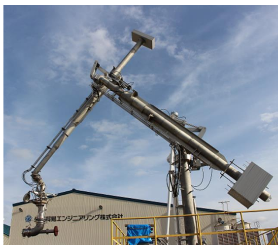
図 5. 開発した液化水素用ローディングシステム
