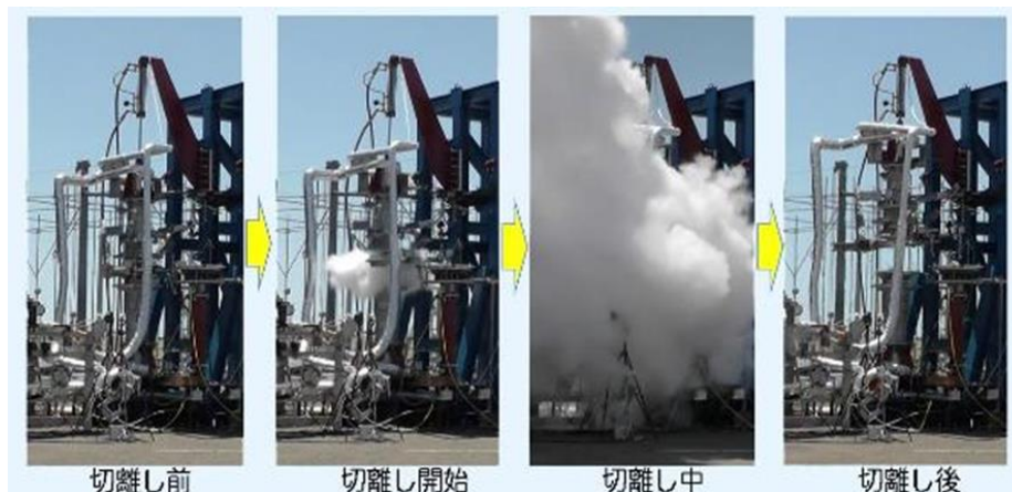
図3. 液化水素を用いた ERS 性能確認試験（離脱試験）
