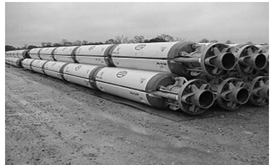
図 34 浮体モジュールが装着されたライザージョイント [18]
