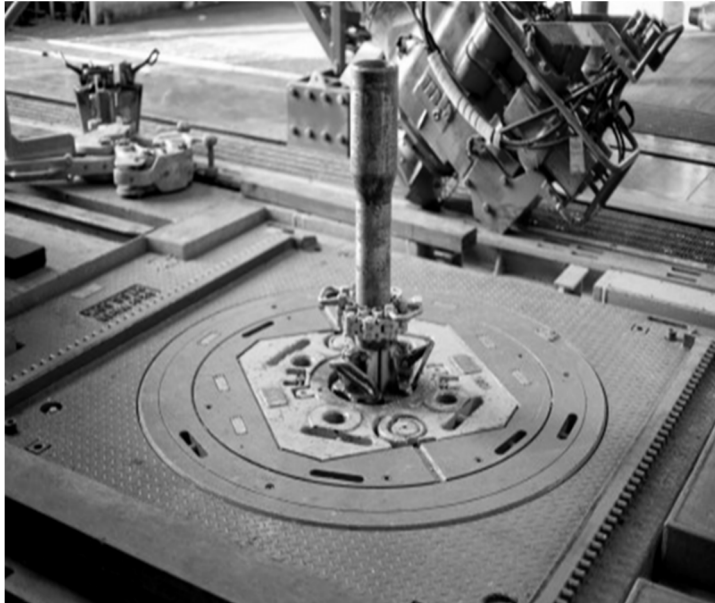
図 51 ロータリーテーブル/掘削パイプ上端がスリップでテーブルの孔に固定されている。後方の赤い装置はアイアンラフネック [32]
