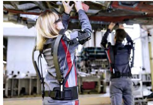
頭上作業用外骨格型ロボット（出所：AUDI）
