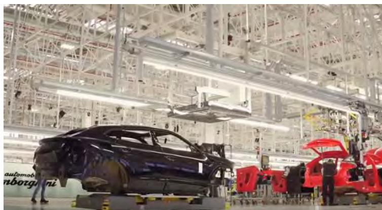
自走式ロボット (AGV) による移動 (出所 : Cars BOOM<sup>10</sup>)
