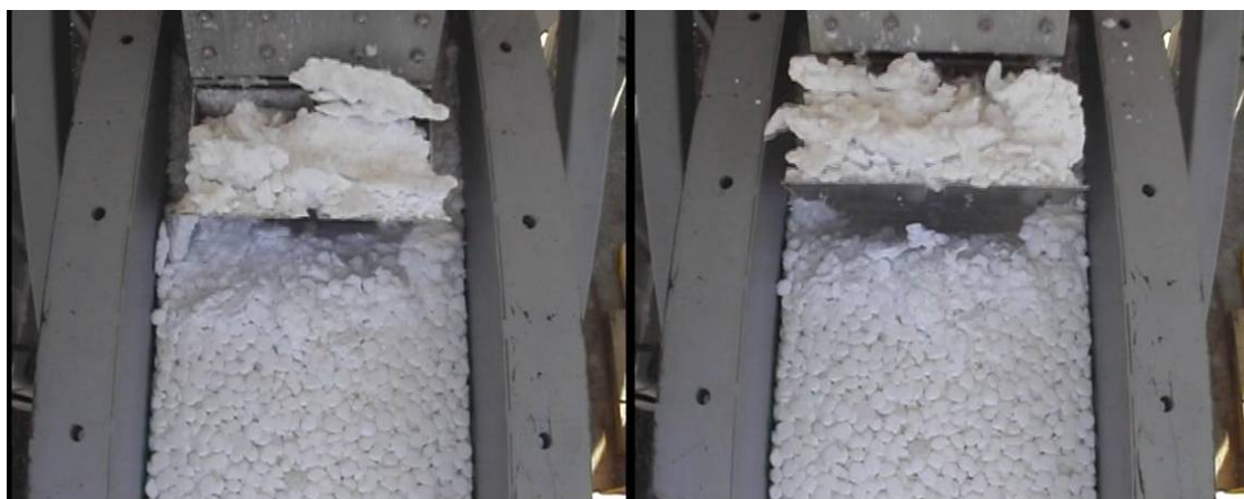
図 4.2-4 掻き取り深さ 200mm、バケット速度 100mm/s、容器速度 10mm/s
