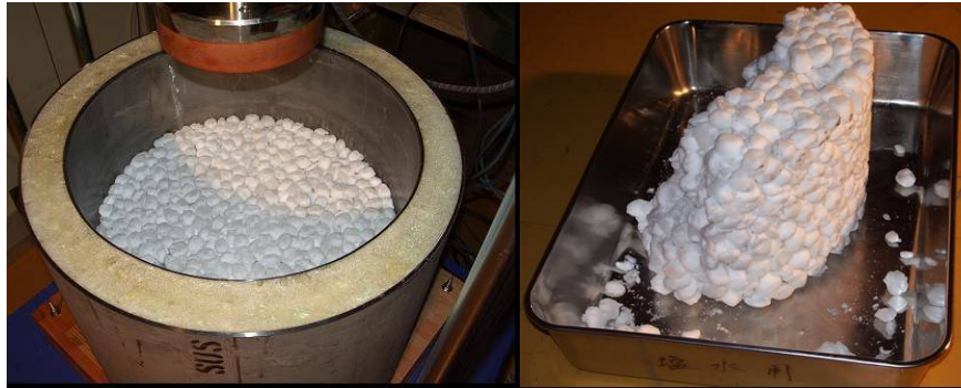
図 3. 2-6 動荷重試験後の固着した MGHP
