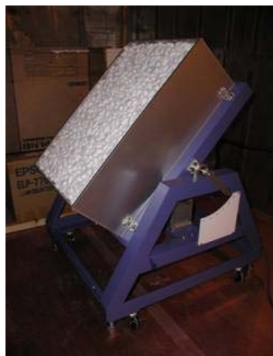
図 3.1-2 傾斜箱試験実施状況
