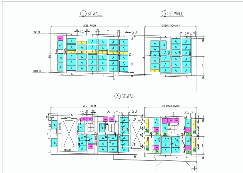
図 2.2.1 鋼壁への貼り付け図 (例)
