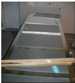
図 2.3.11 カセットパネル裏面への制振材の貼り付け
