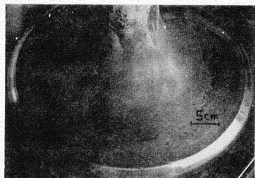
第3.2.5.7図 破損の進行状況を示す実例
