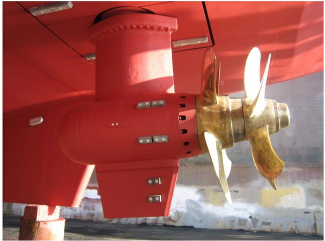
図 2. 7. 2 重反転ポッド型 SES の船尾部
