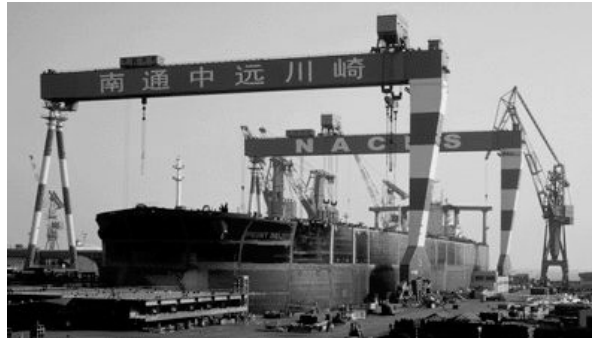
300t*116m 造船所の大型ガントリークレーン(南通中遠)
