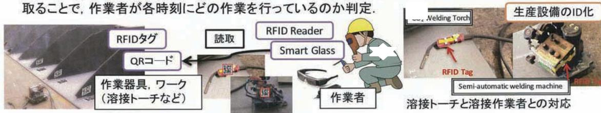
スマートグラス/QRコード及びRFIDリーダ/RFIDタグを活用した作業の見える化
