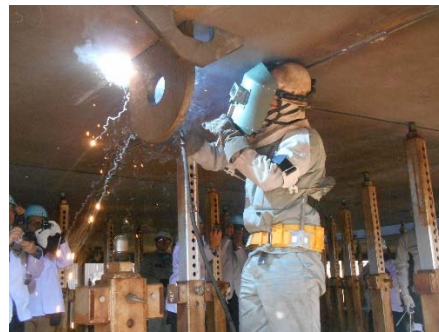
タイプ A による上向き吊りピース溶接作業のデモンストレーション
