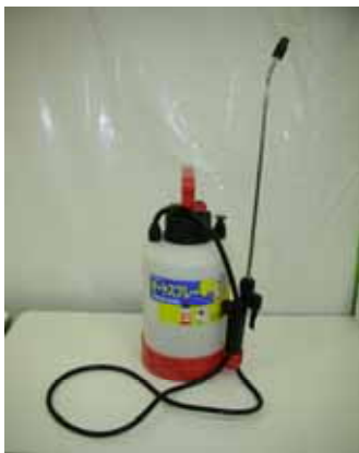
写真 5. 散水に使用した器具 (オートスプレー -value AS-2500N)
