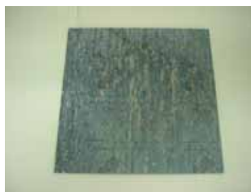
写真3 フランジパッキン
