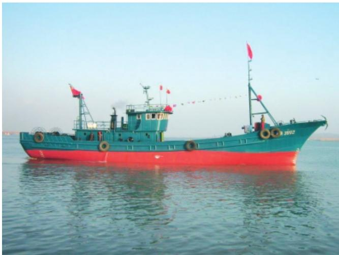
入選理由：艀部線型の改善に重視し、波が甲板に上がることが減少し、船尾部の船型を改善し、加大水線の長度を増加し、波作り（Wavemaking）の抵抗力を減少し、快速性を高める。船、エンジン、プロペラを合理的に配合し、メインエンジンの出力が一定となる時に、大きな減速比ギアボックスを選択し、プロペラの回転速度を下げ、立ちキールを深くして軸線を低くし、プロペラの直径を大きく、プロペラの効率を有効的に高め、また、立ちキールの高度を増加して空船の重心高度を下げることができ、漁船の安定性を改善する。漁民の話しによると、当該漁船は外形が美しく、配置が合理で、リア甲板の作業面積が広く、航速が速く、風抵抗力が強く、機電設備が整備され、漁獲機械が便利で信頼性が高い、生活施設が快適で、燃料消費が低い。
