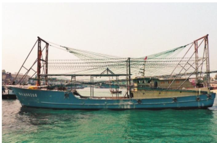
入選理由：当該船型は広西地域の漁民が 1990 年代に開発された木造のライトルアー漁船船型をベースに最適に設計されたもので、最大の特徴は捕獲作業の時に網具の作業方式にあり、船首部と船尾部に分布されている 4 本のフレームを利用して網具を船底から放したり収集したりでき、船員 5 人いれば、捕獲作業ができ、安全性がよい。当該漁船には安全・環境保全・経済的・省エネのディーゼルエンジンが搭載され、エンジンとプロペラの試合が合理で、自動操舵装置が搭載され、通信・ナビゲーター等捕獲補助設備が先端で、ユーザーフレンドリーな設計レベルが高く、省エネ効果が明らかで、特に南沙海域等遠海漁区での生産作業に適する。
