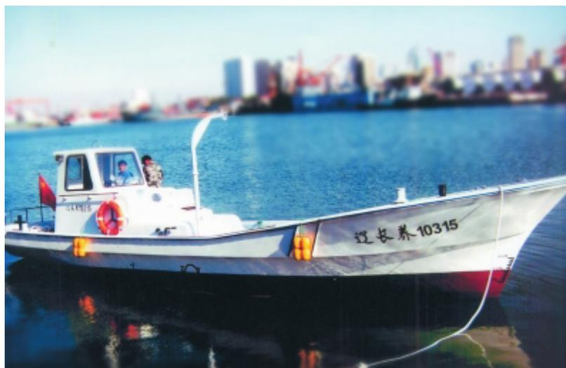
入選理由：船舶モデル試験及び実船応用の結果によると、当該船型の技術性能が優れている。同じ種類の作業の木造船と比べ、メインエンジンの出力が小さく、船体の表面が滑らかで、抵抗力が小さく、省エネ効果が明らかである。
