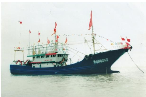
入選理由：主にニシン、ナマズ、イカ等中層・上層の魚の捕獲に用いられ、捕獲強度が割りと弱いため、漁業資源への破壊力が小さい。捕獲作業が機械化で、フィッシュポンプとブームが使用され、直接に捕獲した魚を漁業補助船に入れ、5～6人で捕獲操作ができ、省力で省燃料、経済的で省エネである。冷海水冷凍技術が用いられ、漁獲物の新鮮保持能力が高い。魚誘い込みにおいては新型光源が採用され、照度が強く、エネルギー消費が低い。二重底オイルタンクとバラスト水タンクが採用され、環境保全で快適である。船の航行持続力が 6,500 mile 以上である。魚槽の容量が大きく、エンジンルームには船用冷凍機ユニットを 2 セット設置され、魚槽の温度が $-20^{\circ}\text{C}$ 以上に達する。船首にはバルバボウ (bulb bow) が設置され、航海方向の安定性と快適性が高められる。船首にはスラスト装置が設置され、網リング内に操縦が柔軟的である。下沈式外側キール (鋳鉄) が採用され、船舶の安定性が有効に高められる。
