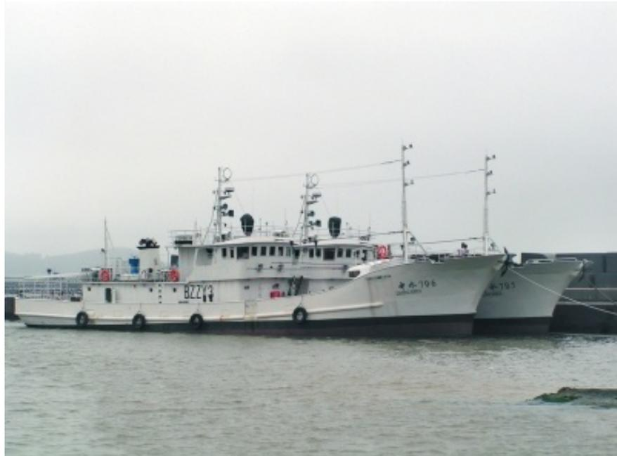
入選理由：良好な航海性能を保証する下で、捕獲作業のプロセスと漁獲物加工のプロセスを合わせて、連続生産ラインを形成する合理的な配置にする。副キールが設けられ、船体の重心が低くされ、船安定性のアップに有利である。低温船室（-40℃）、冷凍船室（-25℃）、冷海水船室（-2~+1℃）が設けられ、冷凍能力が高められ、漁獲物の鮮度保持が高められ、漁獲物の腐食が減り、経済効果が高められる。汚水処理システム及び油水分離システムが設けられ、海洋への汚染が減少される。漁獲物保鮮において、独特の一つの冷凍システム二つの冷却方式（直接冷却システムと間接冷却システム）が用いられて、漁獲物の保鮮効果が明らかにアップされる。
