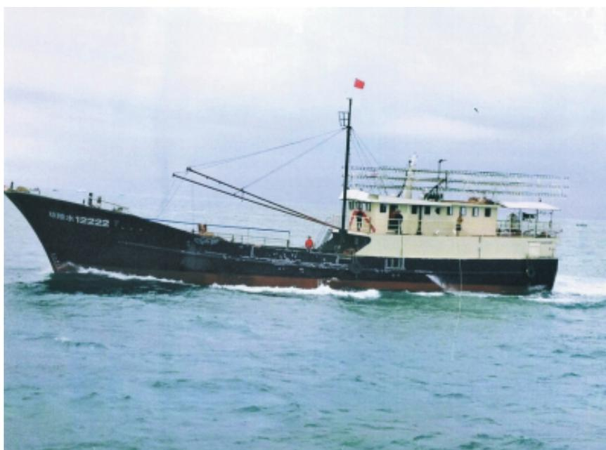
入選理由：当該捕獲作業船型は海南海域漁民の捕獲作業の特徴及び経済的で低建造価格の要求に従って、全長 38m ほどに確定し、設計業者は漁船の基準に従って、元北部湾と西沙海域にて作業する漁船及び海南島周辺漁場にて作業している既存の全長 33m、35m、36.5m 等船型の総合性能・特徴をベースに最適に設計し、実船の安定性を大きく改善し、原材料を減少し、メインエンジンの出力を減少し、燃料消耗をも減らし、推進の効率をアップし、航海作業の利便性を高め、省エネ・排出減の効果が明らかであり漁民からも好評である。
