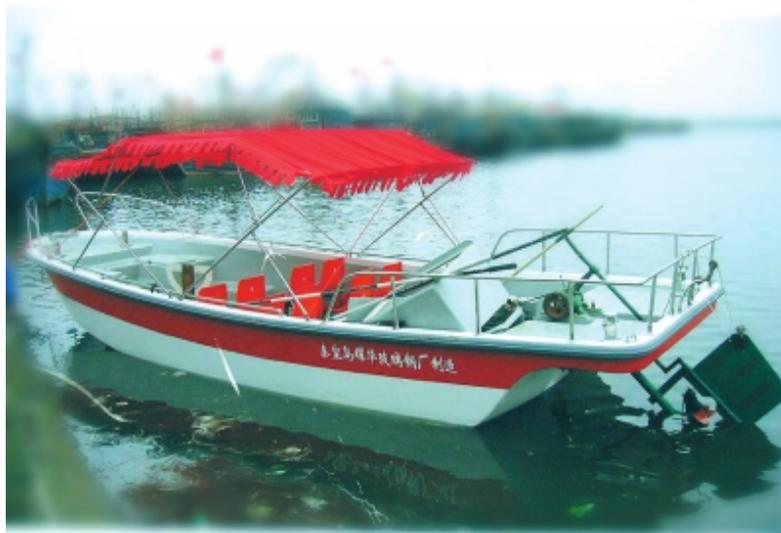
入選理由：河北省における伝統的な小型漁船の船型をベースに最適化された船型で、エンジンとプロペラの相性がよく、経済的で省エネ、構造設計が合理的で、建造価格も適切で、沿海作業方式に適する。2週間の航行試験結果では、漁船の各技術性能が基準に達し、安定性が良く、作業が便利である。
