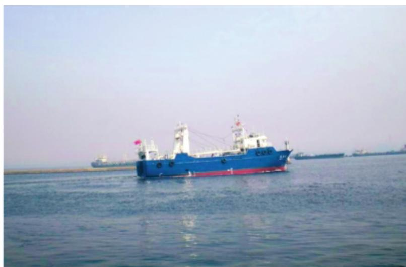
入選理由：サイズが小さいが、深海波において連続航行・作業ができるため、大連理工大学に委託して静水抵抗試験と振動等試験を行い、船型の係数に対しベスト化設計を行い、船型を細長型に転じ、安定性、耐波性と適航性の向上を全体的に考慮し、安全性の向上と居住性の改善が実現できた。構造のベスト化設計を通じて、鋼材の利用率と船室スペースの利用可能率を高め、空船の重量を減らし、貨物の積載量を増加し、品質を保証する上で、建造コストを減少させ、労働生産力を高め、建造期間を短縮した。各状態に必要な航速と推進力に満たすため、可変ピッチプロペラが搭載され、先端な捕獲設備鮮度保持の冷蔵設備と漁業補助用ナビゲーター等設備が搭載されている。
