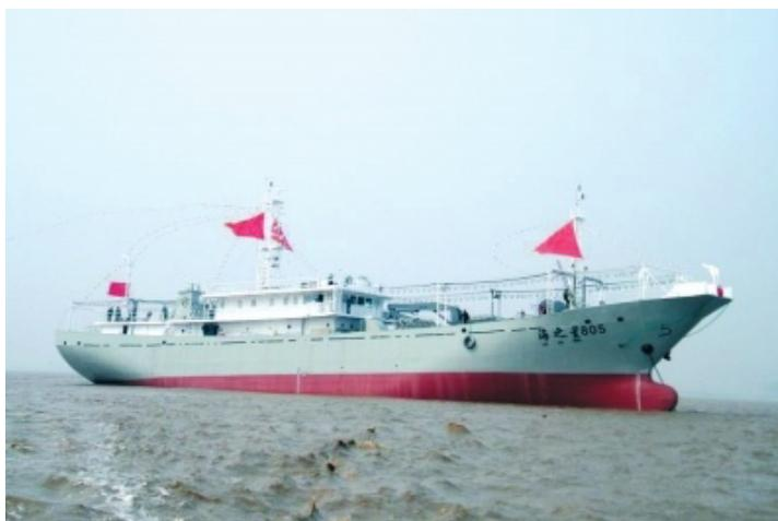
入選理由：鋼製、横骨フレーム式、二層甲板、球状船首、ディーゼルエンジン駆動、シングルプロペラ、シングル舵の船尾エンジン型漁船である。線型は基本配置をベースに安定性を確保し、経済性を優先的に考慮し、スピードも兼ねて考慮することにより最適に設計される。サイズの確定と搭載設備においては、技術性と経済性を同時に重視する上に、経済性をより重視し、建造価格をダウンさせ、船型の推進にメリットがある。船室の容量が大きく、これは西南大西洋海域での作業需要を考慮し、捕獲量も多いことから十分な燃料を積まなければならない。帰る時、オイル槽と魚槽は通常同時に一杯にならないため、オイルと魚の積み方によって合理的な浮き状態を調整することができる。
