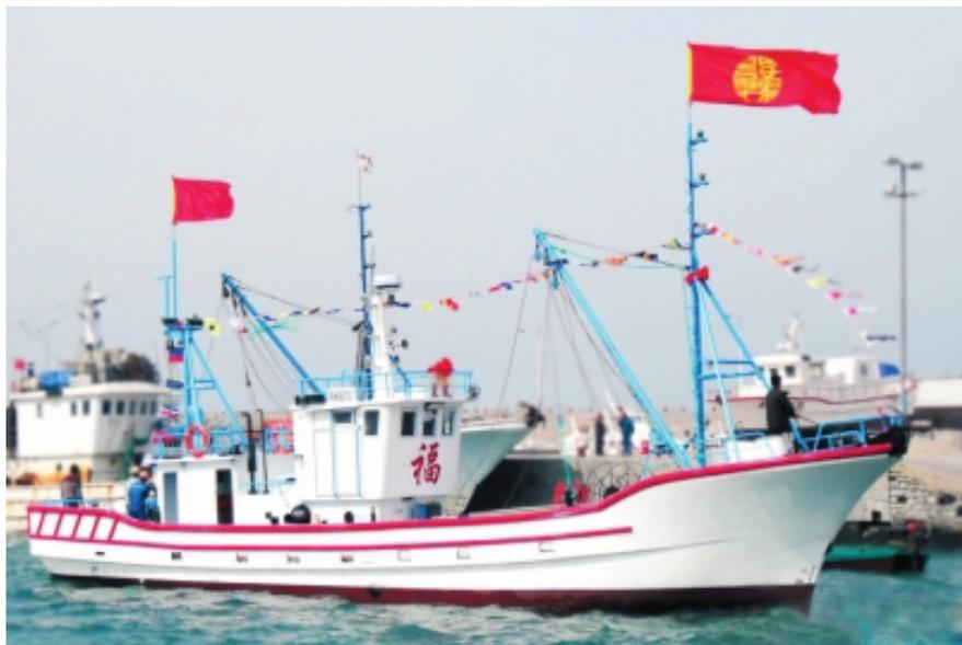
入選理由：使用された FRP 材の密度が小さく、強度が高く、弾性が良い等特徴を持ち、FRP 漁船の抗波性能がよく、航行の安全性を保証することができる。FRP は瞬間耐高温性能、耐酸腐食特性、磁性がない等特徴を持っている。当該船型の設計が環境保全・省エネで、FRP 漁船の表面は滑らかで、船体が軽い、抵抗力が小さい、航速が速い、燃料消費が低い、清浄しやすい、清潔で美しい等環境に良いメリットがある。FRP 漁船の耐用年数は一般的に 30 年以上あり、鋼製漁船の 1.6 倍、木造船の 4 倍となっているため、経済性、社会性、生態性においても優位性が高い。
