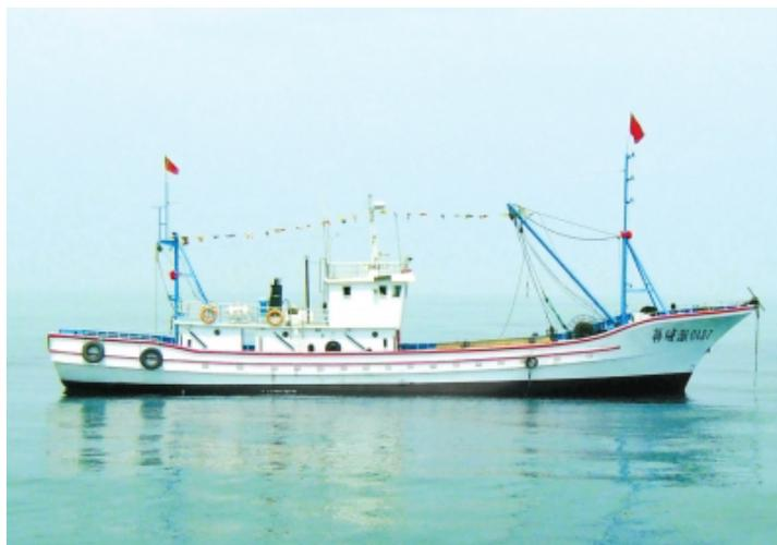
入選理由：技術性能から見ると、FRP 漁船は鋼製漁船や木造漁船より航速が速く、保温性能が良好であるメリットがある。環境保全においては、鋼製漁船はドック修理時には錆び処理しなければならず、環境汚染をもたらすことになり、且つ時間がかかり、修理代もかかる。一方、FRP 漁船のドック修理では、高圧水ジェットで喫水線以下の海洋生物を洗い流せばよい。このように、ドック修理期間が大幅に短縮され、毎年のドック修理費用は鋼製漁船の 20～30%である。経済性と省エネ排出減から見ると、同じ船型の FRP トロール網漁船と鋼製トロール網漁船と比べ、燃料が 11.11%ほど節約でき、FRP 漁船の評価寿命は鋼製漁船より 10 年以上長い。
