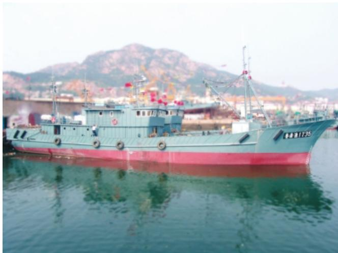
入選理由：一種の新型、排水量が大きく、冷凍能力が高く、冷蔵船室の容量が大きく、設備が先端で、性能が優れており、省エネの中型冷凍トロール網漁船である。船型が設計される時、数回に渡ってベスト化され、安全性を満足しながら、ユーザーの需要を最大限に満足する。また、船員の捕獲作業の便利さと安全性を保証し、生活環境も快適で、航行方向の安定性と回転性を持っている。漁獲物が急速に冷凍(初期温度 32℃、最終温度-15℃)された後、冷蔵魚槽(-18℃)に入れて保存させ、凍結時間 7 時間、毎日の凍結量 25.2t、冷蔵魚槽の漁獲物積み量 200t である。船室の区分と船室の配置が良く、沈没抵抗性がよく、船の浮き状態をコントロールでき、リスクを避け、安全性を大きく高める。建造価格が安くて実用性、技術レベルが高く、市場の見通しが非常によいと見られる。
