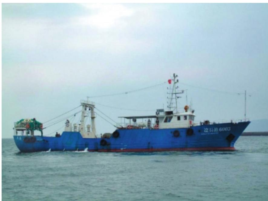
入選理由：一層甲板、長艙楼、船尾エンジンルーム、船尾スライドシングルトロール網漁船であり、元船型をベースに型幅を大きくし、エンジンルームの長さを短縮し、魚槽の長さを延長し、魚槽の容量を拡大したため、経済効果が高められる。メインエンジンの出力とダクトプロペラの直径を増加し、トロール網の引き力を高めたため、魚の捕獲能力がアップされる。建造プロセスにおいて、一部の配置を直し、居住性が高められ、また、大きいマスト上のランプ及びブームの位置を調整して、捕獲作業が更に便利になり、経済効果も高められ、実用性が更に高い。
