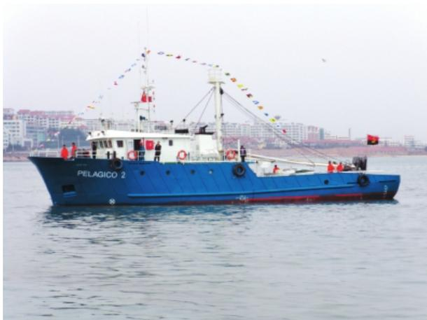
入選理由：船型を設計する時、数回に渡って最適化させ、安全性を高くさせながら、ユーザーの機能要望を満足させ、捕獲作業の便利さ、安全性及び生活環境を保証する。当該船型の船室分布が合理で、沈没抵抗性がよく、船舶の浮き状態をコントロールでき、リスクを避け、船舶の安全性を高めた。当該船舶はまた鮮魚の運搬機能を持ち、漁獲物の貯蔵においては-1℃の冷海水システム（RSW）が採用され、冷凍機を合理的に選び、先端な海水スプレーシステムをもって魚槽の水溫を設定値の-1℃にコントロールでき、漁獲物のベスト鮮度を維持することができる。市場需要を満たした新型の巻き網漁船として、作業方式はグリーンの遠洋漁業の要求を満足でき、漁獲物運搬中の安全性を保証でき、漁獲物の鮮度をアップするため、漁獲物の価値を高め、経済効果が非常に高い。
