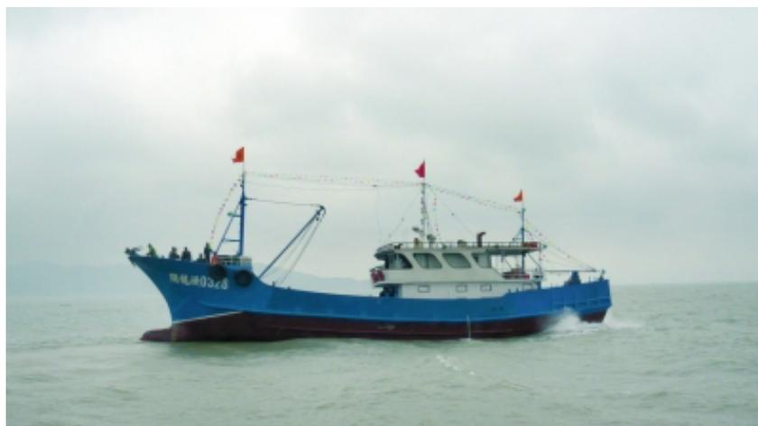
入選理由：福建南部海域における典型的な新型シングルトロール/流刺し/ケージポット作業を行う多目的漁船の船型である。傾斜試験の結果によると、安定性等各項目の指標は基準に満足するほかに、十分な余裕量を持っている。球状船首、球状船尾、大型船尾低速ダクトプロペラが採用されるため、抵抗力が減少され、推進効率が向上され、引き力が高められ、プロペラの振動が減少される。比較的の高い横向強度と十分な破損沈没抵抗性能を持っている。船の側面には、上フェンダーと下フェンダーが設置され、高い耐衝撃性を持っている。汚水廃油ケースと汚水廃油海岸コネクタが設置され、油性廃水の収集と排出ができる。油圧船首スラスト装置が使用され、漁船の柔軟性が向上され、漁港において迅速に出入り・寄ったり離れたりすることができ、仕事の効率が高められる。台湾の技術を用いて製造される風力排気ファンが設置され、エンジンルームの通風効果が改善され、電力駆動の使用が要らなくなり、省エネで環境保全である。
