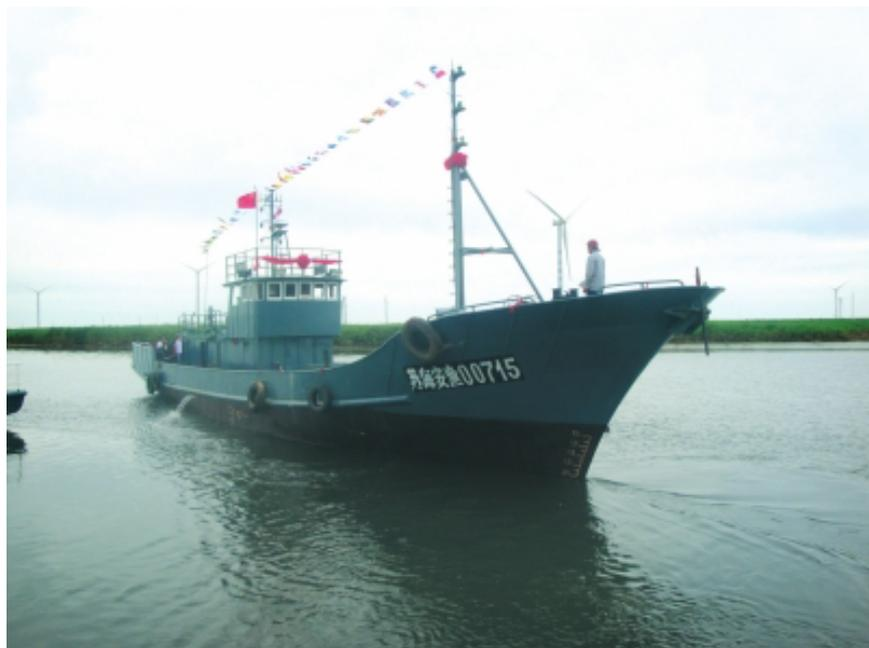
入選理由：黄海と渤海海域に適用し、トロール網作業ができ、刺し網及びその他の漁業作業もでき、柔軟性が高く、ユーザーの経済効果を向上させることができる。引き力を高めるため、大型直径のダクトプロペラを使用し、船尾部の船型がより細く、プロペラが適当に後ろに移動して、流れがよりスムーズになり、軸線が下に移動して、プロペラの浸水深度が増加され、推進効率が大きく向上される。プロペラのブレードに対しベスト化して、船、プロペラ、エンジンの配合がよりよく、省エネ効果が明らかとなる。比較的の大きい副キールを持っているため、船舶の波抵抗と安全性が高められる。航行の試験結果及びユーザー使用結果の実証で、本船はけん引力が大きい、航速が速い、安定性が良く、省エネ、構造が合理的で、作業範囲が広い等特徴を持っている。
