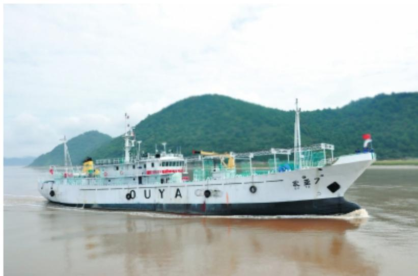
入選理由：鋼製、横骨フレーム式、二層甲板、球状船首、ディーゼルエンジン駆動、シングルプロペラ、シングル舵の船尾エンジン型漁船である。船型は基本配置をベースに安定性を確保し、経済性を優先的に考慮し、スピードも考慮することにより最適な設計がなされる。搭載設備では主に安全性・適用性・標準性・信頼性・統一性・経済性と環境保全等要素を考慮した上で決められる。船室の容量が大きい。これは西南大西洋海域での作業需要を考慮し、十分に燃料を積まなければならないし、捕獲量も多いからである。帰る時、オイル槽と魚槽は通常同時に一杯にならないため、オイルと魚の積み方によって合理的な浮き状態を調整することができる。
