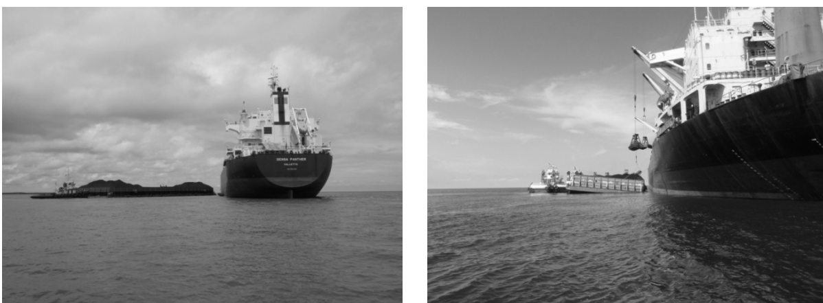
図 3.2 河口付近における石炭の洋上積替え
