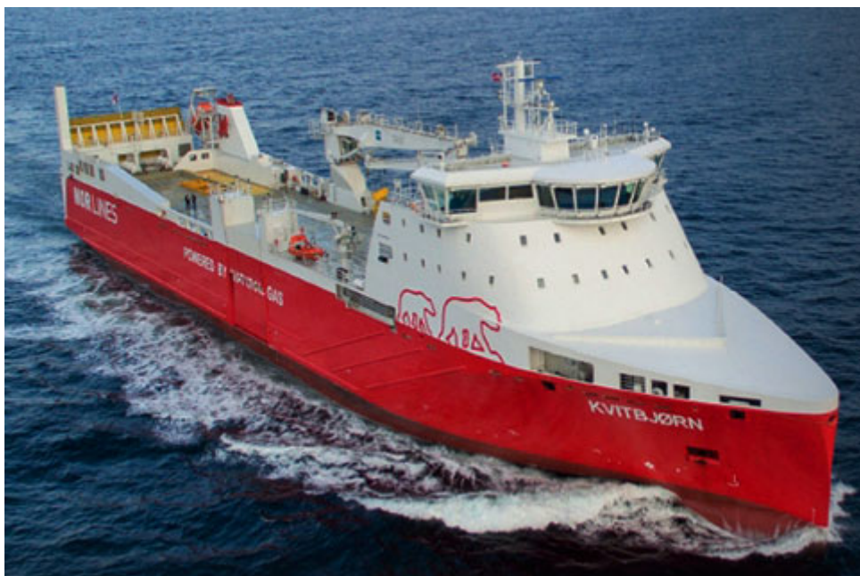
LNG 駆動貨物船「MS Kvitbjørn」（出典：Rolls-Royce）
