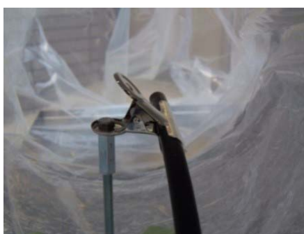
参考図 4.15 チューブ配管を使用した場合の排気ダクトの測定例
