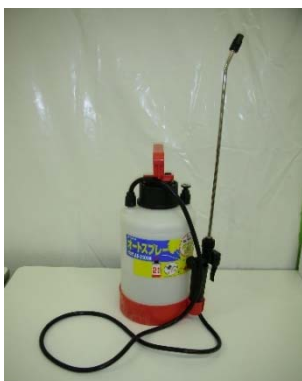
参考写真5.5 散水に使用した器具 (オートスプレー ε-value AS-2500N)
