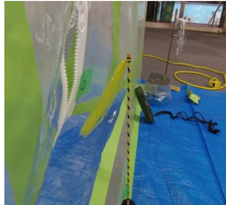
参考図4.11 吹き流しによる確認
