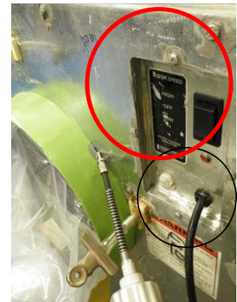
参考図3.31 電源コード取り付け部 ダクト接続口
