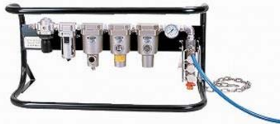
図5.2.9 マスク用空気清浄装置の例 †
