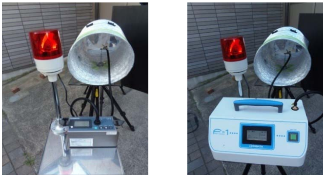
参考図 4.18 排気ダクト内の測定時に警告灯を設置した例
