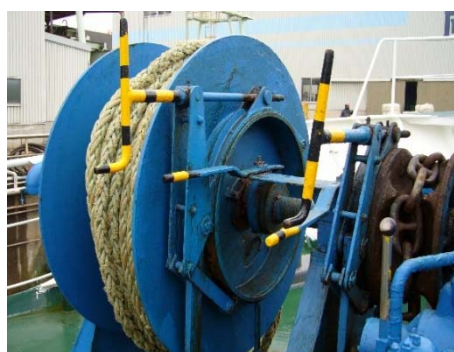
図 2-11 ウィンドラスのブレーキライニング
