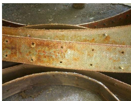
図 2-11 ウィンドラスのブレーキライニング
