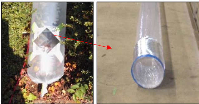
(x) ビニールダクトの先端部分を環状の支え（アルミ製ダクト）を重ねて使用した例
