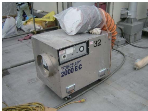
参考図 3.11 集じん・排気装置の例
