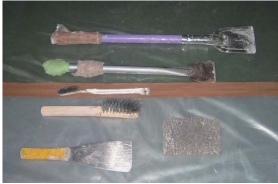
参考図 3.34 除去作業用の手工具の例
