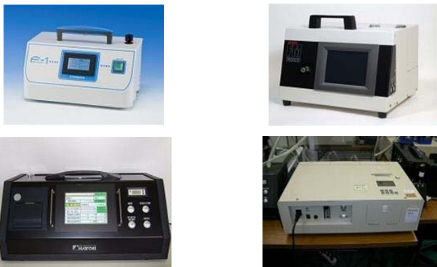
参考図 4.4 繊維状粒子自動計測器の例
