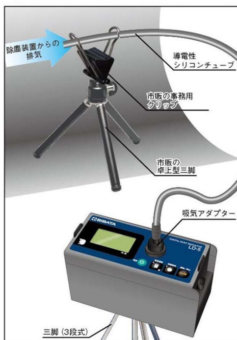
参考図 4.15 チューブ配管を使用した場合の排気ダクトの測定例
